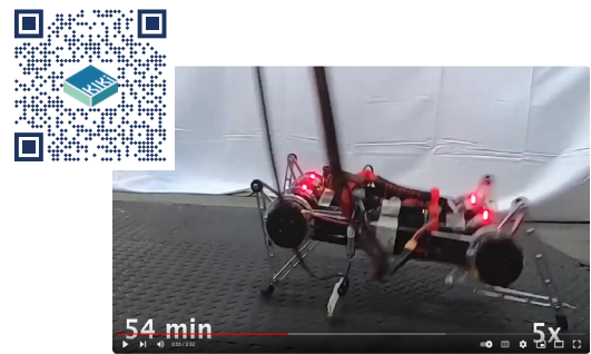
Dieser Roboter lernt dank Verstärkendem Lernen zu laufen.
